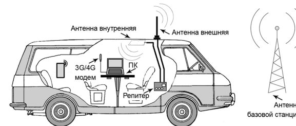
Схема 2 – Пример использования автомобильной антенны при работе с репитером
