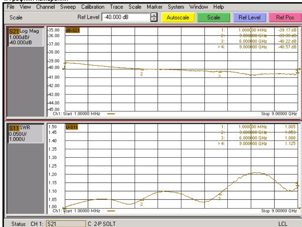
Графики для АЧХ - Log Mag, при отсчётном уровне равном -40 дБ, и для КСВ – SWR
