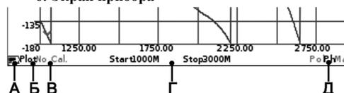
На экран прибора выводятся результаты сканирования частотного задания в виде установленных пользователем графиков и диаграмм. Текущие настройки прибора, диапазон сканирования, тип выводимого графика или диаграммы и другая важная для пользователя информация расположена на нижней строке экрана. Рассмотрим эту информационную строку слева направо.
